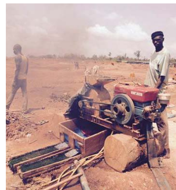
Un mineur d'or artisan utilise un concasseur à Bondoukou, en Côte d'Ivoire.
